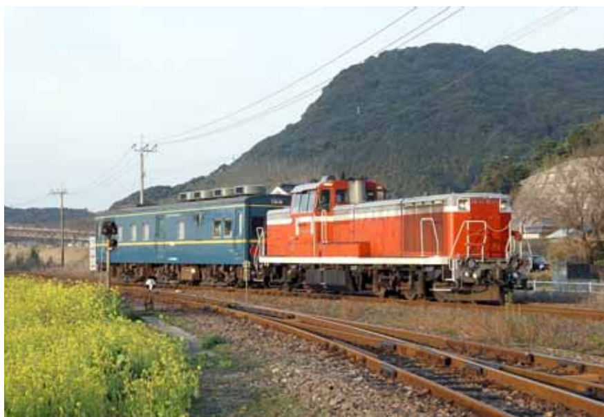
・マヤによる軌道狂いの検査
